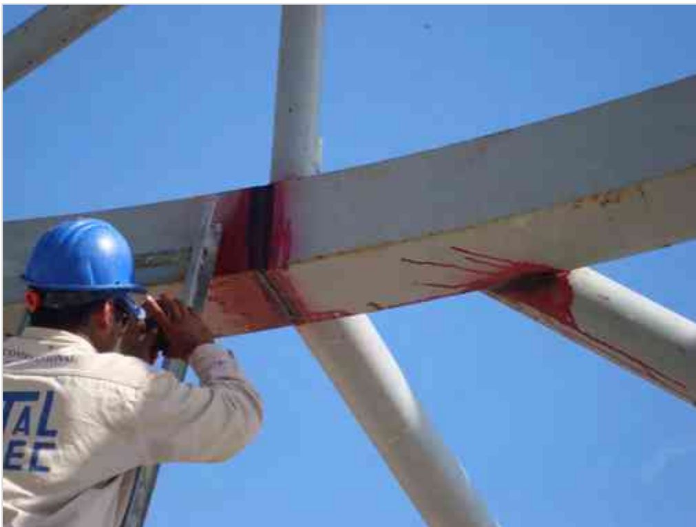
Imagen 111 Aplicación de elemento penetrante para prueba de líquidos penetrantes.
