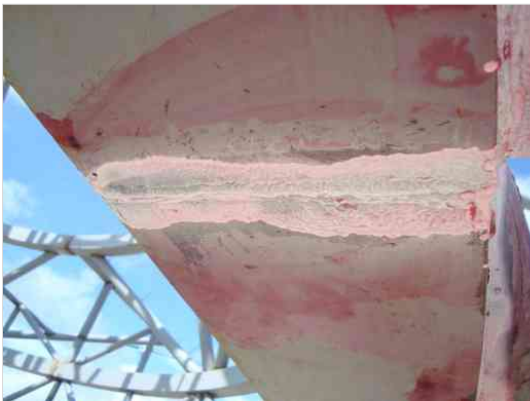
Imagen 112 Resultados de Pruebas de Líquidos Penetrantes Satisfactoria.
