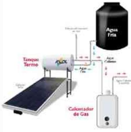
Imagen 165. "Diagrama de cómo conectar un calentador solar". Fuente: (<http://calentadorsolarlux.blogspot.mx/>)
