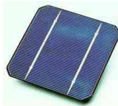
FIG. 6.10 Celda fotovoltaica de 10 por 10 centímetros, normalmente son color azul oscuro.
