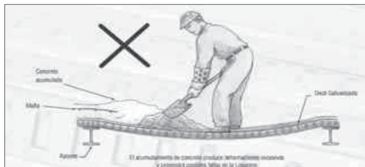
Fig. 17. Forma incorrecta de vaciar el concreto.
