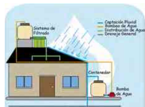
F27. Captación de Agua pluvial
