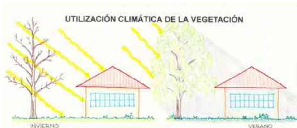
F26. Regulación de radiación solar
