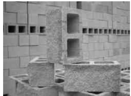
F57. Block Hueco De Concreto
