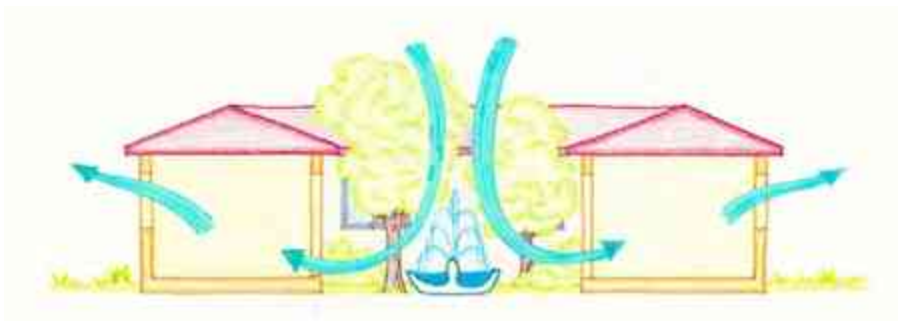
F24. Ventilación a través de un patio
