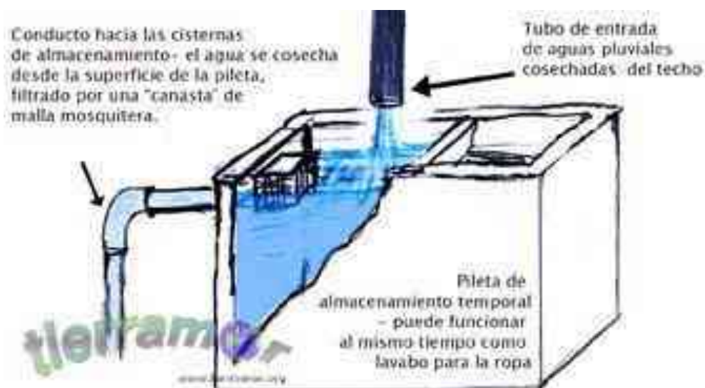
Imagen 41. Cisterna de agua pluvial. Fuente. www.terramor.com
