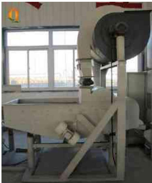
Imagen 12. Limpiador de semilla, energía 14.59 kw, capacidad de entrada 800-1000 kg/hora. Fuente: www.qiaopai.com
